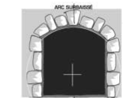
L'arc surbaissé est une portion d'arc de cercle posé sur les jambages.
