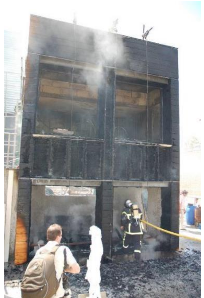
Groupe scolaire Louise Michel à Issy-les-Moulineaux (92) – 2013 – Essai au feu LEPIR 2 – 30 minutes Maître d'ouvrage : Ville d' Issy-les-Moulineaux – Architectes : Sonia CORTESSE – Bernard DUFOURNET
