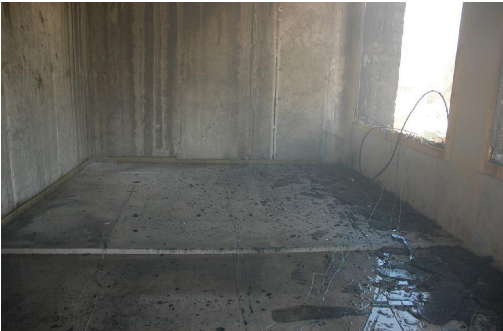
Groupe scolaire Louise Michel à Issy-les-Moulineaux (92) – 2013 – Essai au feu LEPIR 2 – 30 minutes Maître d'ouvrage : Ville d' Issy-les-Moulineaux – Architectes : Sonia CORTESSE – Bernard DUFOURNET
