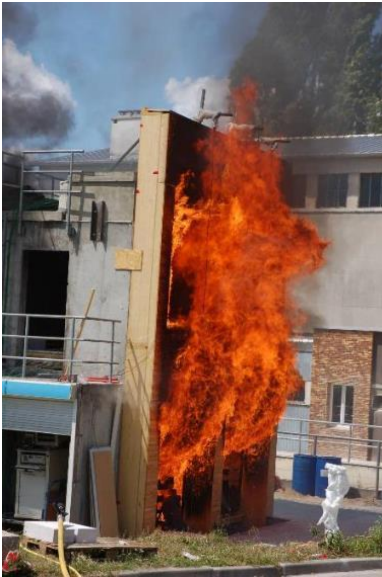
Groupe scolaire Louise Michel à Issy-les-Moulineaux (92) – 2013 – Essai au feu LEPIR 2 – 30 minutes Maître d'ouvrage : Ville d' Issy-les-Moulineaux – Architectes : Sonia CORTESSE – Bernard DUFOURNET
